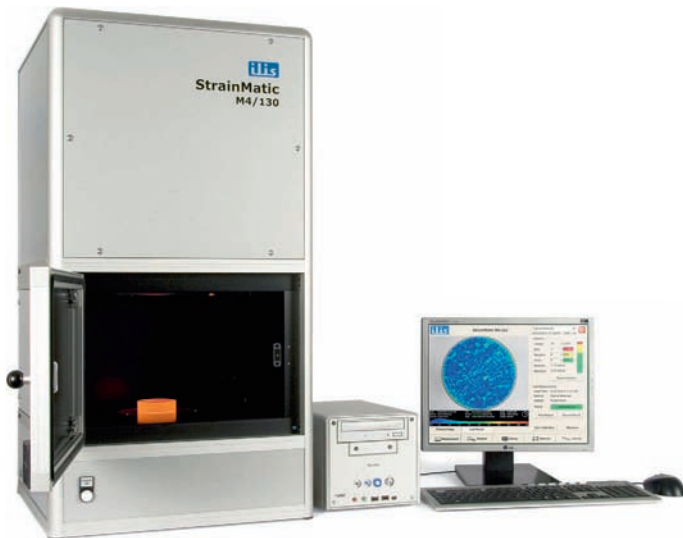
Bild 5: Realisiertes Messsystem zur automatischen Bestimmung der örtlichen Verteilung und Orientierung der Spannungsdoppelbrechung
